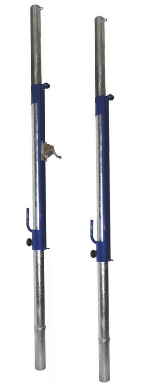
GS0365 Impianto pallavolo beach volley beach tennis professionale Impianto pallavolo da interrare, monotubolare, in acciaio zincato. Completo di manopola tendirete con sistema antiscatto. Altezza palo mt 2,80 diametro esterno mm 80. L'impianto è funzionale per la pallavolo, il beachvolley e il beach tennis utilizzando l'apposita rete con maglia più stretta (GS0923). Bicchieri per interraggio inclusi.
